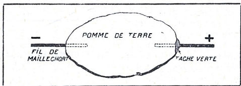
UNE POMME DE TERRE PEUT DÉCELER LA POLARITÉ DES FILS D'UNE LIGNE
