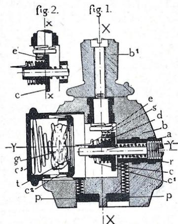
*b<sup>1</sup>, bouton - e, excentrique - s, pointe de chercheur - d, douille porte-chercheur - b, base de détecteur - a, axe chercheur - r, ressort de l'axe - c, collerette de la douille - c<sup>1</sup>, chercheur spiral - p, prises de courant - c<sup>2</sup>, couvercle de cuvette - t, tamis d'indéréglage - c<sup>3</sup>, cuvette porte-cristal - g, galène.*
