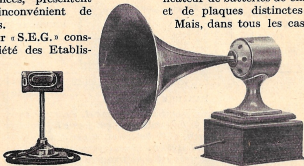
FIG. 1. — POSTE HAUT-PARLEUR GAUMONT POUR COMMUNICATION DANS UN SEUL SENS.
